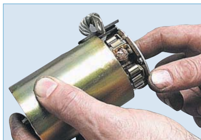
Извлекаем из корпуса статора якорь с щеткодержателем.
