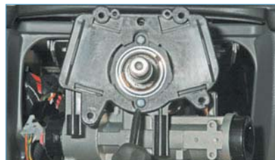
Отворачиваем два винта крепления соединителя.
