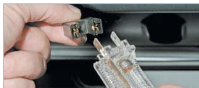
...отсоединяем от плафона колодку проводов.
