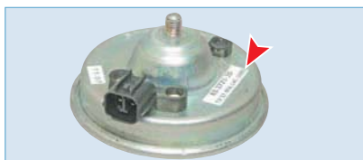
Маркировка звукового сигнала
