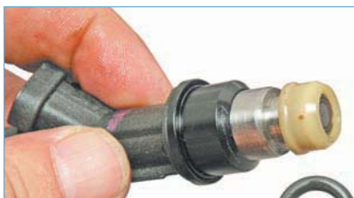
...и нижнее резиновые уплотнительные кольца с наконечников форсунки.
