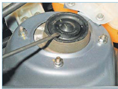
...отверткой поддеваем крышку верхней опоры...
