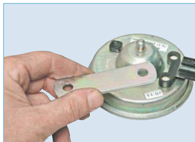
Снимаем кронштейн звукового сигнала.
