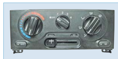
Блок управления отоплением, вентиляцией и кондиционированием воздуха
