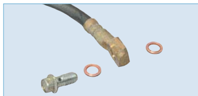
Соединение нижнего наконечника переднего тормозного шланга уплотнено двумя медными шайбами.
