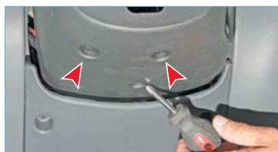
Крестообразной отверткой отворачиваем три самореза крепления нижнего кожуха рулевой колонки.
