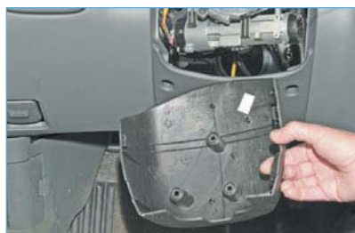
Снимаем нижний кожух рулевой колонки.
