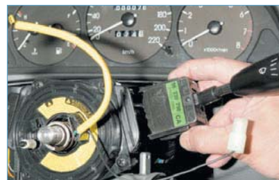
...вынимаем правый подрулевой переключатель из соединителя.
