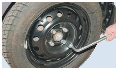
Штатным колесным ключом ослабляем затяжку болтов крепления снимаемого колеса.
