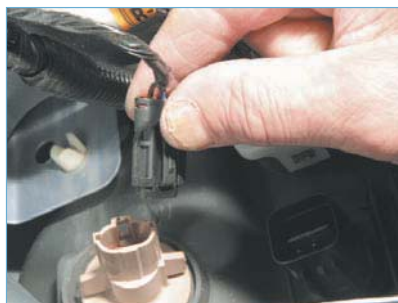
Нажав на фиксатор, отсоединяем колодку проводов от патрона лампы указателя поворота.
