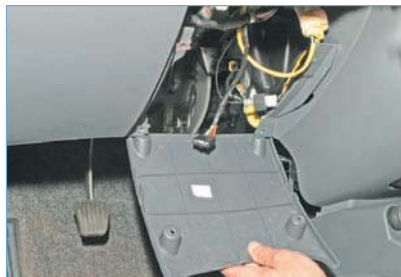
Снимаем нижнюю накладку панели приборов.
