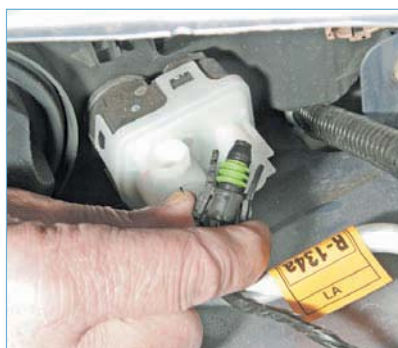
Сжав фиксаторы, отсоединяем колодку проводов от разъема мотор-редуктора регулятора направления пучка света фары.
