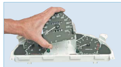
Внимаем спидометр из корпуса комбинации приборов.
