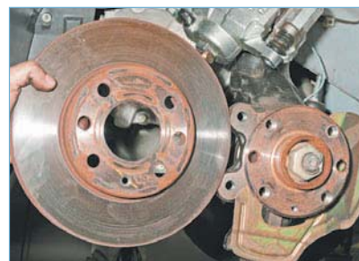
...и снимаем диск со ступицы.
