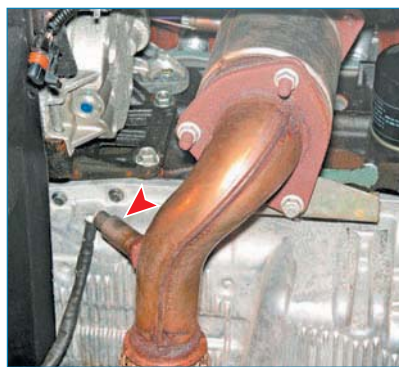
Диагностический датчик концентрации кислорода (показан стрелкой)
