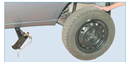
...и снимаем колесо.
