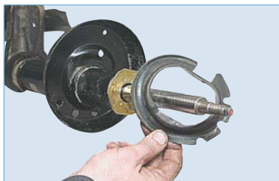
Вынимаем резиновую прокладку из нижней опорной чашки пружины.
