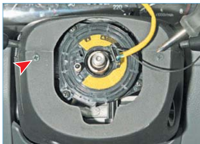
...крестообразной отверткой отворачиваем два самореза, соединяющих верхний и нижний кожухи рулевой колонки между собой.
