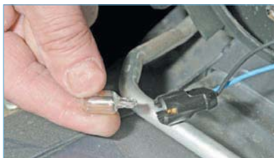
Вынимаем лампу из патрона. Новую лампу W5W устанавливаем в обратной последовательности. Для замены лампы указателя поворота...
