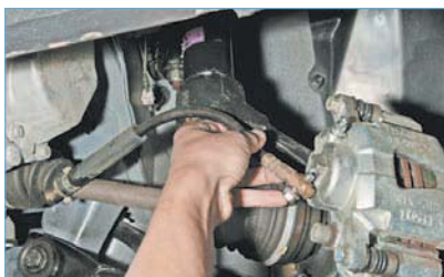
Снимаем передний тормозной шланг.
