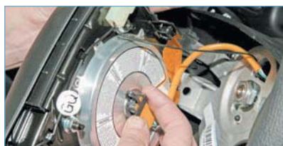
Поднимаем фиксатор колодки проводов подушки безопасности.
