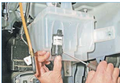
Поддев отверткой, сдвигаем насос...
