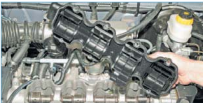
Снимаем крышку головки блока цилиндров.
