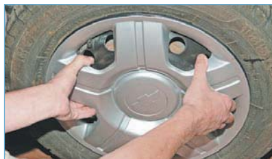
Обеими руками сдергиваем декоративный колпак с обода колеса, преодолевая усилие пружинного кольца.
