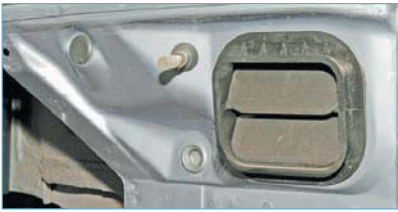
Вентиляционные отверстия под задним бампером закрыты резиновыми шторками
