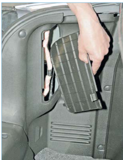
...и снимаем крышку обивки багажника.
