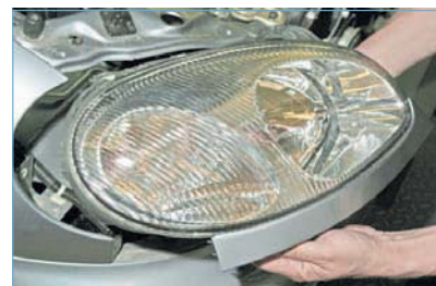
Снимаем блок-фару с декоративной накладкой.
