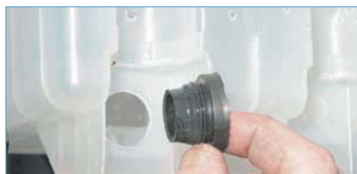
Вынимаем из отверстия бачка резиновую уплотнительную втулку.
