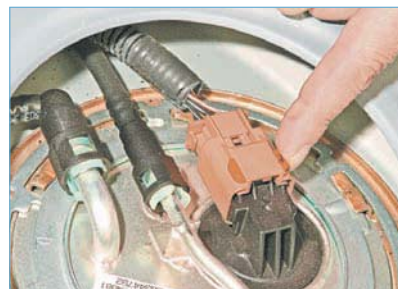
...сдвигаем блокиратор колодки жгута проводов системы управления двигателем (оранжевого цвета)...
