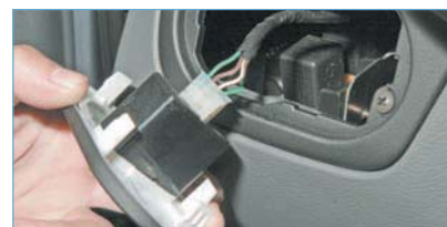
...и вынимаем переключатель из панели приборов.
