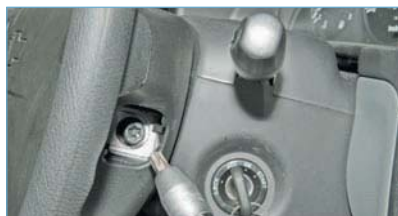
Ключом Torx «TR-50» (см. «Приложения» с. 248) отворачиваем винт крепления подушки безопасности.
