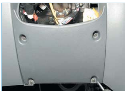
Крестообразной отверткой отворачиваем четыре самореза крепления нижней накладки панели приборов.
