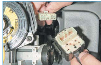
Нажав на фиксатор колодки, отсоединяем колодку жгута проводов от подрулевого переключателя.
