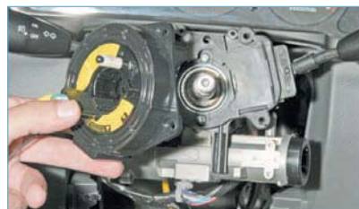
Снимаем барабанное устройство с соединителя переключателей. Снимаем подрулевые переключатели.
