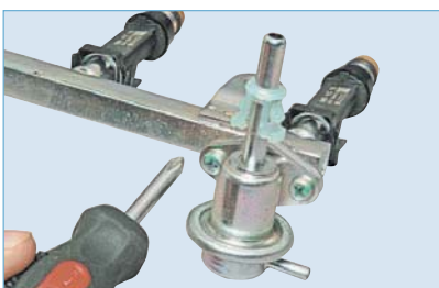
Крестообразной отверткой отворачиваем два винта крепления регулятора к топливной рампе...
