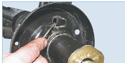
Трубным ключом отворачиваем гайку корпуса стойки (можно также зажать гайку в тисках и поворачивать стойку)...
