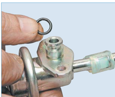
Снимаем уплотнительное кольцо регулятора давления топлива.
