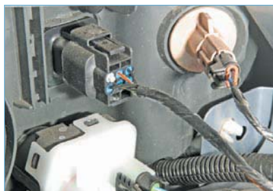
...поворачиваем патрон лампы против часовой стрелки...
