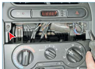
...крестообразной отверткой отворачиваем два самореза крепления накладки панели приборов.
