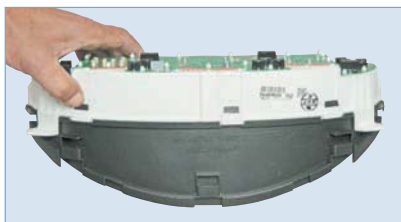
Аналогично отжимаем три фиксатора накладке сверху комбинации...
