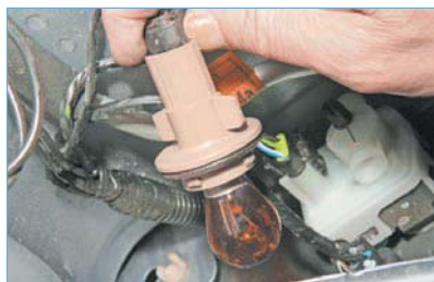
...и вынимаем его из корпуса блок-фары.
