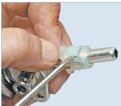
Для снятия фиксатора наконечника трубки сливной магистрали поддеваем его плоской отверткой...
