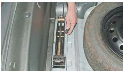
Отворачиваем рукоятку крепления домкрата к кронштейну кузова...
