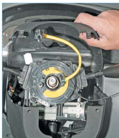
Снимаем верхний кожух рулевой колонки.
