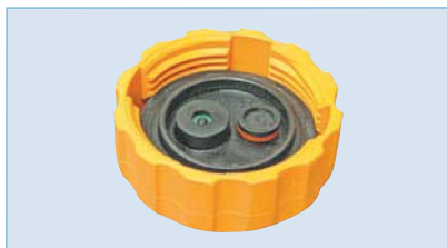
Крышка расширительного бачка
