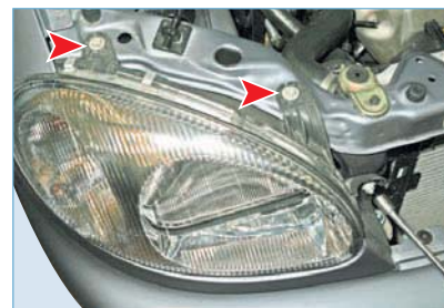
Головкой «на 10» отворачиваем гайку и два болта крепления блок-фары.
