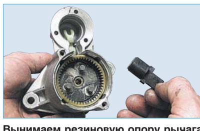
Вынимаем резиновую опору рычага привода.
