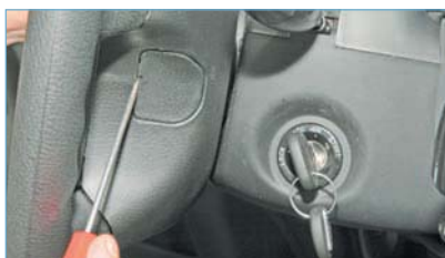
Поддев отверткой, снимаем заглушку на рулевом колесе.
