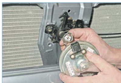
Нажав на фиксатор колодки, отсоединяем колодку проводов от звукового сигнала.
