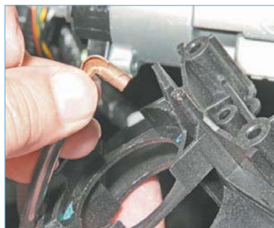
Отсоединяем от соединителя «массовый» провод.
