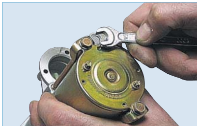
Ключом «на 10» отворачиваем два стяжных болта...
