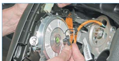
Отсоединяем колодку проводов от подушки безопасности.
