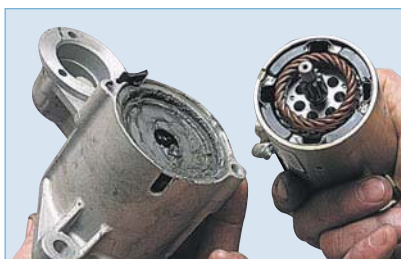
...и отсоединяем корпус статора вместе с якорем от передней крышки.
