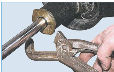
Трубным ключом отворачиваем гайку корпуса стойки (можно также зажать гайку в тисках и поворачивать стойку)...
