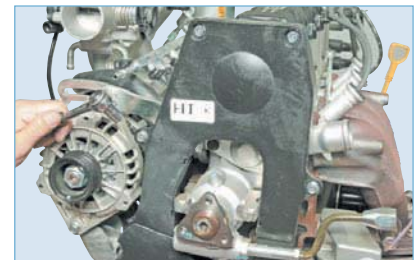
Головкой «на 10» отворачиваем четыре болта крепления верхней передней крышки привода ГРМ ...
