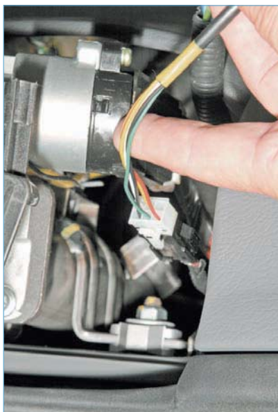
...вытягиваем жгут проводов с колодками из-под рулевой колонки.
