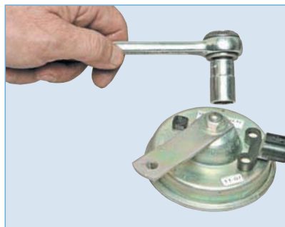
Ключом или головкой «на 13» отворачиваем гайку крепления кронштейна.
