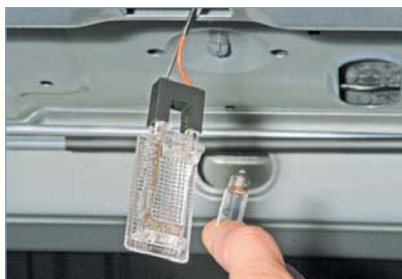
...вынимаем лампу из плафона...
