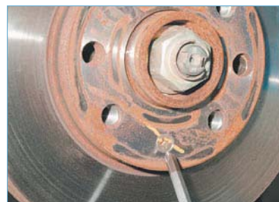
Крестообразной отверткой отворачиваем винт крепления диска тормозного механизма к ступице переднего колеса...
