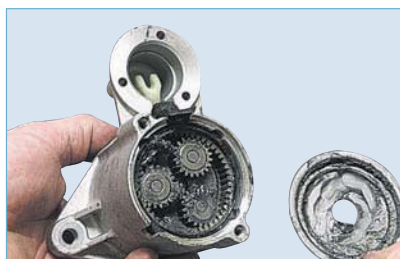
Снимаем защитную крышку планетарного механизма...
