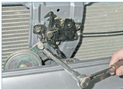
...головкой «на 12» отворачиваем болт крепления звукового сигнала.
