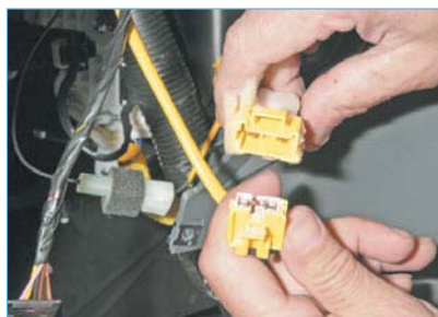
Нажав на фиксатор колодки, отсоединяем колодку проводов барабанного устройства от колодки жгута проводов панели приборов.
