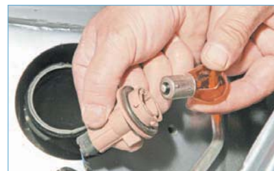
Нажав на лампу, поворачиваем ее до упора против часовой стрелки и вынимаем лампу из патрона.
