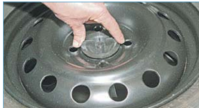
Отворачиваем держатель запасного колеса...
