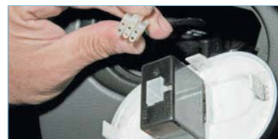
Нажав на фиксатор колодки, отсоединяем колодку проводов от переключателя.
