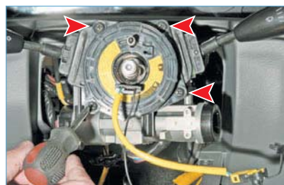
Крестообразной отверткой отворачиваем четыре самореза крепления барабанного устройства.
