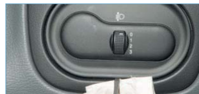
Поддеваем отверткой переключатель регулятора направления пучков света фар...
