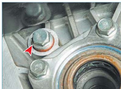
Пробка контрольного отверстия уровня масла установлена на герметике
