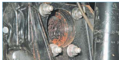
Цапфа заднего колеса крепится четырьмя гайками через щит тормозного механизма к фланцу балки задней подвески
