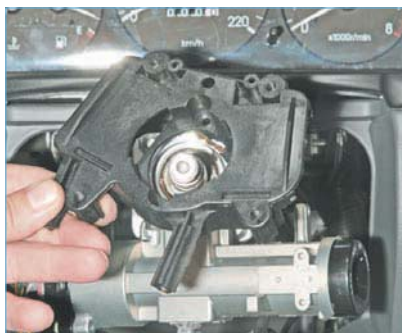
Снимаем соединитель переключателей с рулевой колонки.
