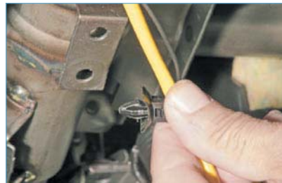
Аналогично снимаем держатель проводов барабанного устройства.
