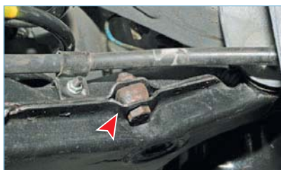
Стабилизатор поперечной устойчивости крепится болтом с гайкой к рычагу подвески.
