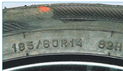
Маркировка шины автомобиля «Ланос»
