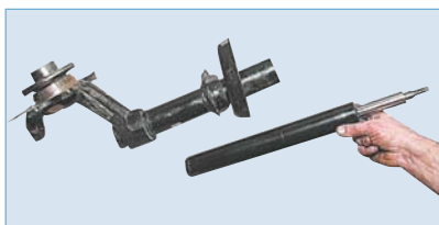
Извлекаем из корпуса стойки амортизатор.
