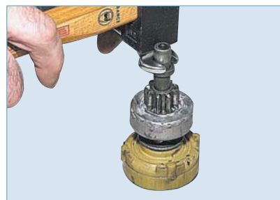
Оперев губки рожкового ключа «на 13» на ограничительное кольцо муфты, наносим удары молотком по ключу и спрессовываем ограничительное кольцо.
