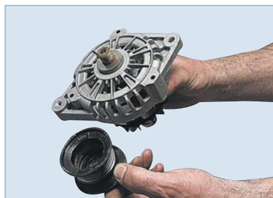
Снимаем с вала ротора шкив...
