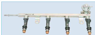
Топливная рампa в сборе с форсунками и регулятором давления топлива
