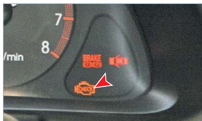
Сигнализатор неисправности системы управления двигателем в комбинации приборов
