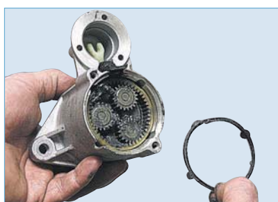
...и уплотнительное кольцо. Вынимаем три шестерни редуктора.
