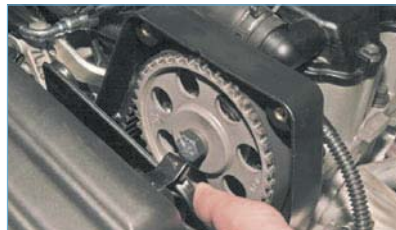
Отведя переднюю крышку от задней, проверяем состояние ремня.
