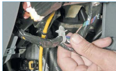
...снимаем держатель жгута проводов с кронштейна рулевой колонки.
