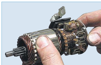
Снимаем щеткодержатель с якоря.
