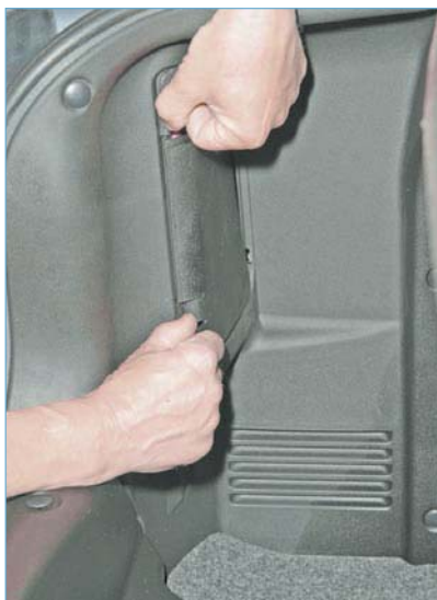
Нажимаем на два фиксатора...
