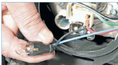
Вынимаем патрон с лампой из корпуса блок-фары.
