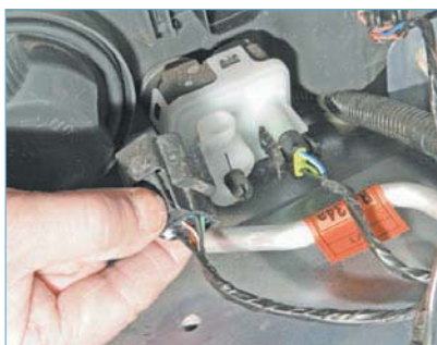
Нажав на фиксатор, отсоединяем колодку проводов от разъема блок-фары.
