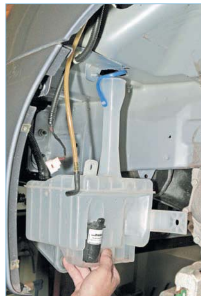
Снимаем бачок омывателя.
