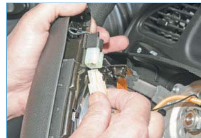
Нажав на фиксатор колодки, отсоединяем колодку проводов от колодки проводов выключателей звукового сигнала.
